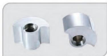
(1) одинарный ротор: используется для транспортировки среды с небольшим количеством крупных зерен, поскольку это рабочее колесо щадяще перекачивает зерна. Недостаток - высокий импульс, низкое давление, малая мощность, поэтому используется редко.
