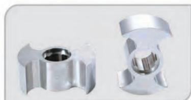
(2) двухлопастной ротор: используется для транспортировки среды со средними или мелкими зёрнами, с низкой степенью повреждения и низким импульсом, производительность меньше, чем у трехлопастного.
